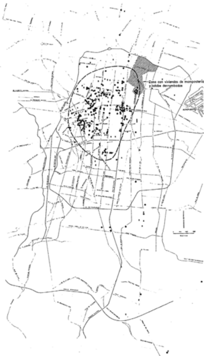
Figura 3. Ubicación de construcciones que sufrieron daño grave (x), o colapso (●).
