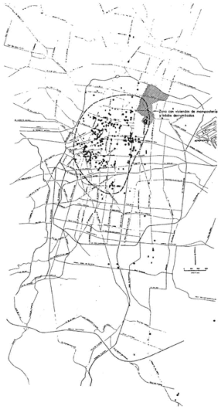
Figura 2. Ubicación de construcciones que sufrieron daño grave o colapso.
