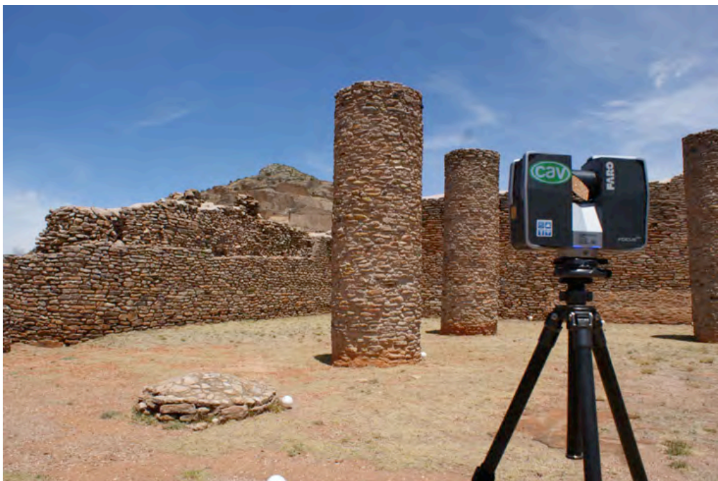
Fotografía realizada durante el levantamiento con escáner láser 3D en sitio arqueológico “La quemada”, Zacatecas, México
