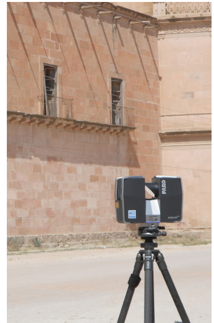
El láser escáner Focus3D X 130 en proceso de captura de datos
